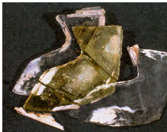
Fig. 15. Alemania, Colonia, Catedral. Foto: Ulrike Brinkmann. Extracción de un vidrio medieval previamente conservado con un vidrio de doblaje y sellado con una película de resina según el método Jacobi
