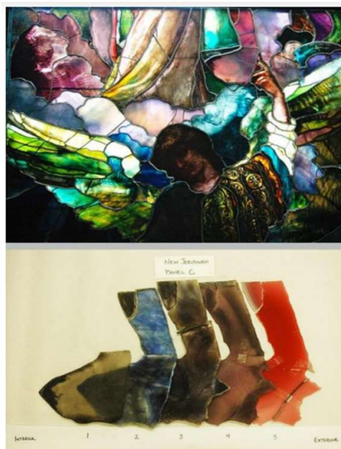
Fig. 1. Estados Unidos, Boston, Trinity Church. "New Jerusalem", John La Farge, 1884. Fotos: Roberto Rosa, Serpentino Stained Glass, Inc. ( http://www.serpentinostainedglass.com/ ) Detalle de unos de los paneles después de la restauración (imagen superior) y de un doblaje formado por cinco vidrios (imagen inferior)
