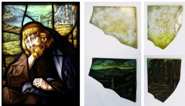
Fig. 6. Segovia, Museo de la Real Fábrica de Cristales de La Granja. Vidriera de la Casa Mauméjean realizada a principios del siglo XX. Fotos: Fernando Cortes Pizano. Detalle de varias piezas con doblajes formados por dos vidrios, los cuales fueron extraídos para su limpieza durante el proceso de restauración
